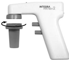
Drehen Sie das Nasenstück (7) vom Griff ab, indem Sie es gegen den Uhrzeigersinn drehen. Halten Sie den oberen Teil des Nasenstückgehäuses fest (7b), drücken Sie den unteren Teil (7f) fest gegen den oberen (7b) und drehen Sie ihn entgegen dem Uhrzeigersinn (nach links). Der obere Teil des Nasenstückgehäuses (7f) löst sich nach ungefähr 1/8 Drehungen.
