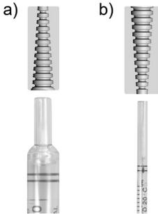
Der Pipettengummi aus Silikon (7e) verfügt über einen speziellen konischen Kanal, der ein festes und dichtes Fassen der Pipette unabhängig von deren Durchmesser sicherstellt.
