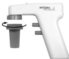
Desatornille la boquilla (7) del asa girándolo en el sentido contrario a las agujas del reloj. Sostenga la mitad superior del alojamiento de la boquilla (7b), presione la mitad inferior (7f) con firmeza contra la mitad superior (7b) y gírela en el sentido contrario a las agujas del reloj (izquierda). La mitad inferior del alojamiento de la boquilla (7f) se soltará tras 1/8 de vuelta, aproximadamente.
