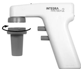
Svitare l'imboccatura (7) dall'impugnatura ruotandola in senso antiorario. Tenere la parte superiore dell'involucro dell'imboccatura (7b), premere la parte inferiore (7f) verso quella superiore (7b) e ruotare la prima in senso antiorario (sinistra). La parte inferiore dell'imboccatura (7f) si sbloccherà dopo circa 1 ottavo di giro.
