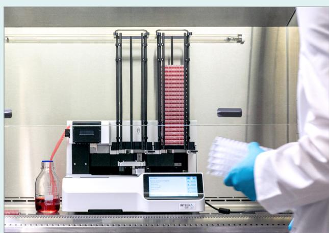
针对液体的无菌分配，WELLJET分液叠板机可轻松放入超净工作台内使用。
