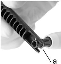
Für 200 µl oder 1000 µl Pipetten schieben Sie das Mehrzweckwerkzeug seitlich auf den Spitzenhalter, bis der O-Ring (a) eine Schleife bildet. Entfernen Sie den O-Ring mit einer Kunststoffpinzette.
