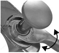
Drehen Sie im Uhrzeigersinn, um das Volumen zu erhöhen (etwas bis zu einer vollen Umdrehung).
