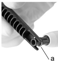
Pour remplacer les joints toriques des pipettes 200 µl ou 1000 µl, glissez l'outil polyvalent par le côté sur le raccord d'embout, jusqu'à ce que le joint torique (a) fasse une boucle. Retirez le joint torique à l'aide d'une pince en plastique.
