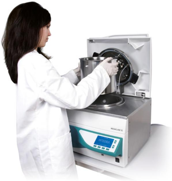
Am Ende des Prozesses wird heißes, steriles Kopplungswasser abgelassen, das unerwünschte Agarrückstände auflöst und entfernt. So werden alle empfindlichen Teile des Geräts vollständig dekontaminiert und bestmögliche Bedingungen für die sterile Medienherstellung geschaffen.
