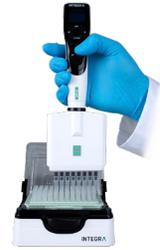
Mit den elektronischen **VIAFLO**-Pipetten muss weder beim Aspirieren noch beim Dispensieren oder Mischen ein Kolben betätigt werden, weshalb der Daumen weniger belastet wird.
