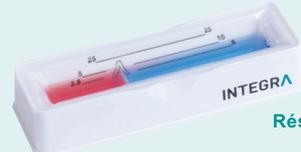
Réservoir à réactif avec séparateur,
