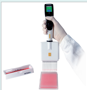
Mehrfachdispensieren Dispensieren von mehreren Aliquoten gleichen Volumens
