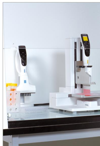
Ces robots de pipetage compacts peuvent être placés dans des enceintes de biosécurité pour le traitement des échantillons stériles et la protection de l'utilisateur, évitant ainsi les risques ergonomiques liés à leur utilisation.
