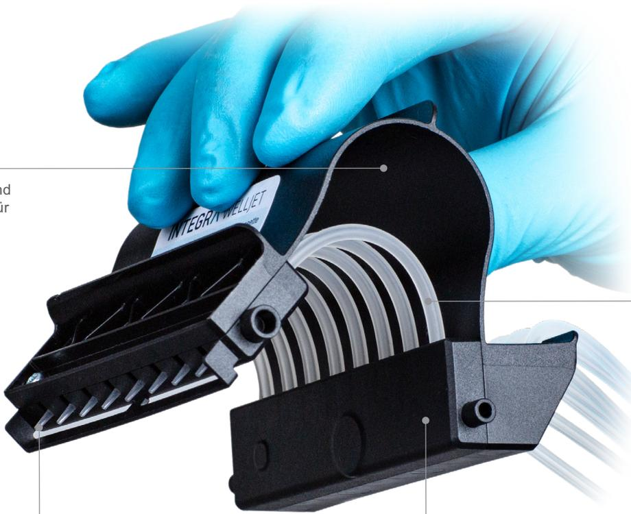
Präzise geformte Silikonschläuche an der Schnittstelle zur Peristaltikpumpe. Keine (erneute) Kalibrierung nötig, da alle Kanäle identisch sind. Patent angemeldet.
