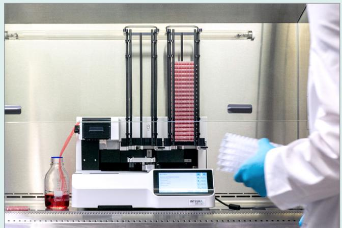
Der **WELLJET** Dispenser mit Plattenstapler hat zum sterilen Dispensieren von Flüssigkeiten in einer Sicherheitswerkbank Platz.
