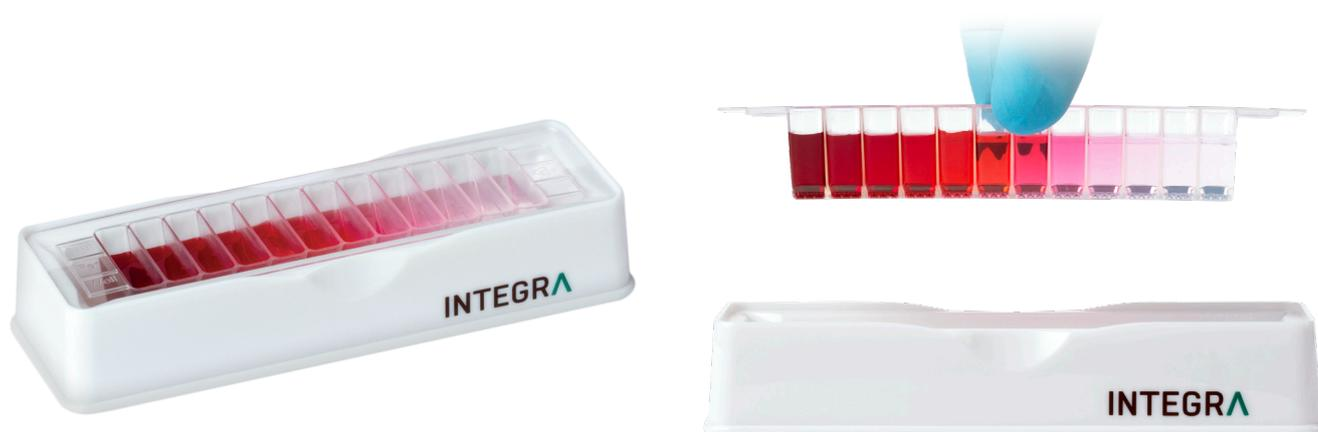
这些多通道储液槽由12个隔室组成，每个隔室容积3 ml，能够贴合地嵌入我们坚固的标准25 ml可重复使用底座。该储液槽9 mm的孔间距与孔板相同，非常适合以8或12通道移液的方式将样品便捷地移入96孔板的整行或整列，是各种液体处理应用的理想选择。
