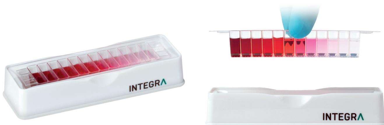
12ウェル試薬リザーバーは、3mlの容量を持つ12のウェルで構成されており、丈夫で繰り返し使えるINTEGRA製25mLベースにのせて使うよう設計されています。このリザーバーは、ウェル間隔が9 mmで96マイクロプレートのウェルの間隔と一致しているため、96プレートの行や列全体に8チャンネルや12チャンネルピペットで分注する場合に便利で、さまざまな液体処理アプリケーションに適しています。
