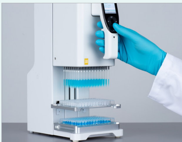
96ウェルプレートから96ウェルプレートへの移し替え
