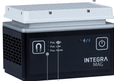
HEATMAGはマグネットと加熱機能を1つの装置に統合し、最高温度65°Cまで対応。高温での磁気ビーズ精製ステップの自動化を可能にします。このユニークな機能は、溶解や溶出の工程において有用です。
