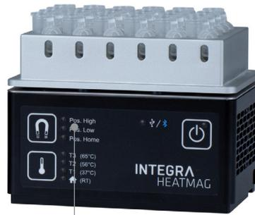
强力磁体，减少磁珠损失：磁珠产出量高且捕获快，同时最大限度地减少残留造成的污染。
