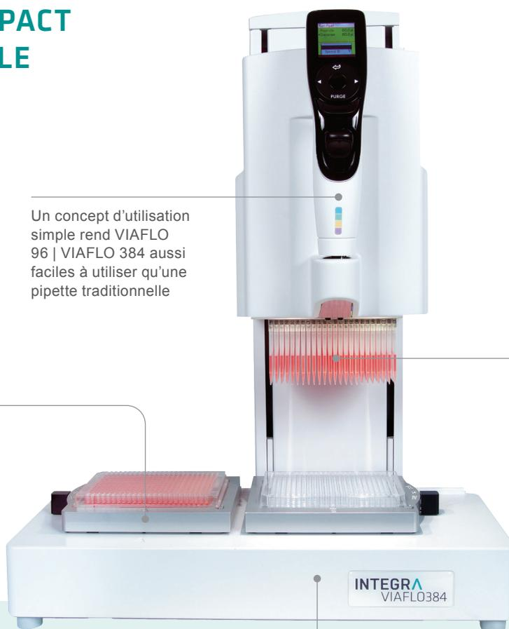
Des têtes de pipetage interchangeables pour garantir la précision au service d'une large gamme d'applications
