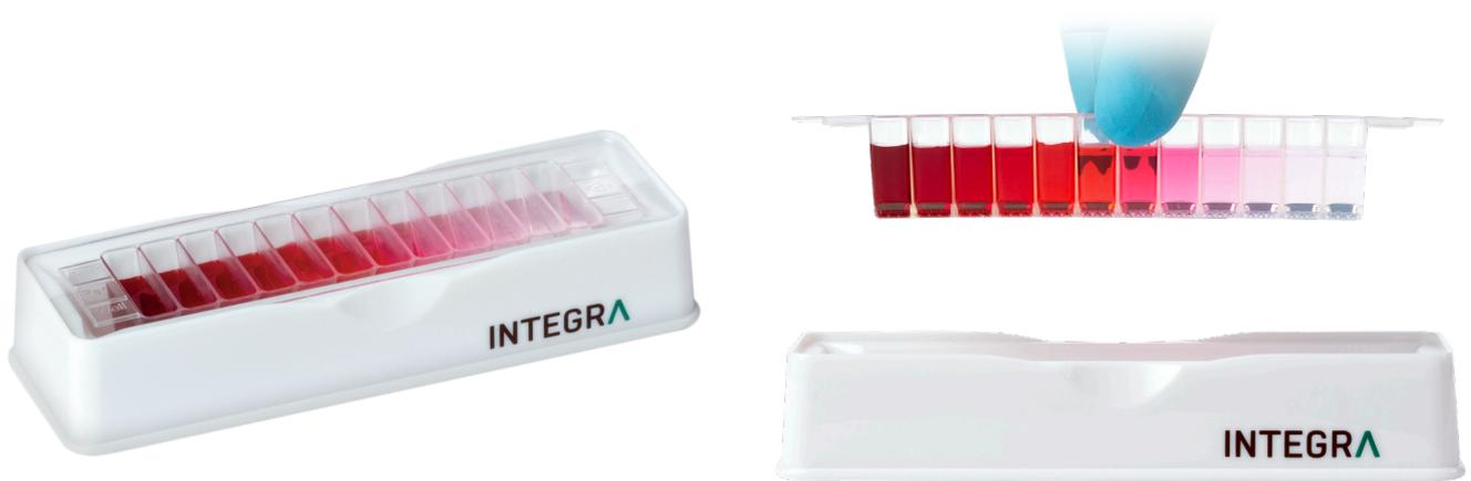
Ces réservoirs pour pipettes multicanaux comprennent 12 compartiments d'une capacité de 3 ml et s'insèrent dans la base réutilisable standard de 25 ml. Ce réservoir est idéal pour tout un éventail d'applications de manipulation des liquides, mais il est notamment optimal pour le pipetage multicanaux de 8 ou 12 échantillons dans toute une rangée ou colonne d'une plaque à 96 puits, les 9 mm d'espacement des puits des réservoirs correspondant à celui des plaques.
