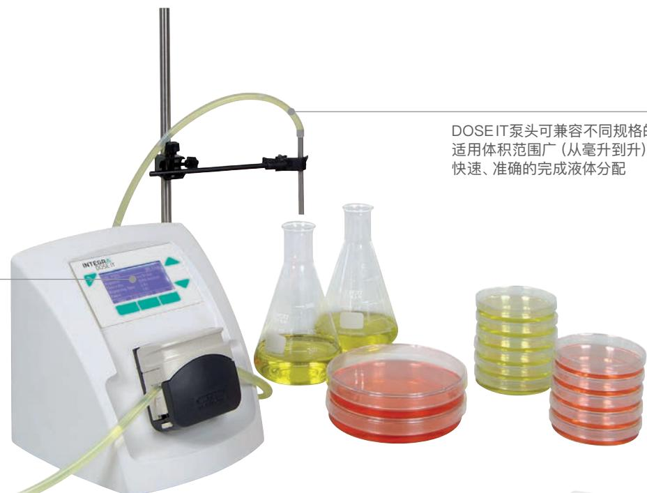
DOSE IT泵头可兼容不同规格的管道，适用体积范围广（从毫升到升），能够快速、准确的完成液体分配
