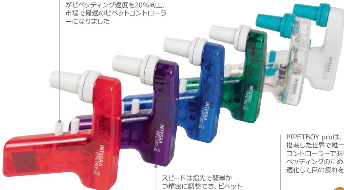
スピードは指先で簡単かつ精密に調整でき、ピペット内の液面レベルを細かくコントロールできます
