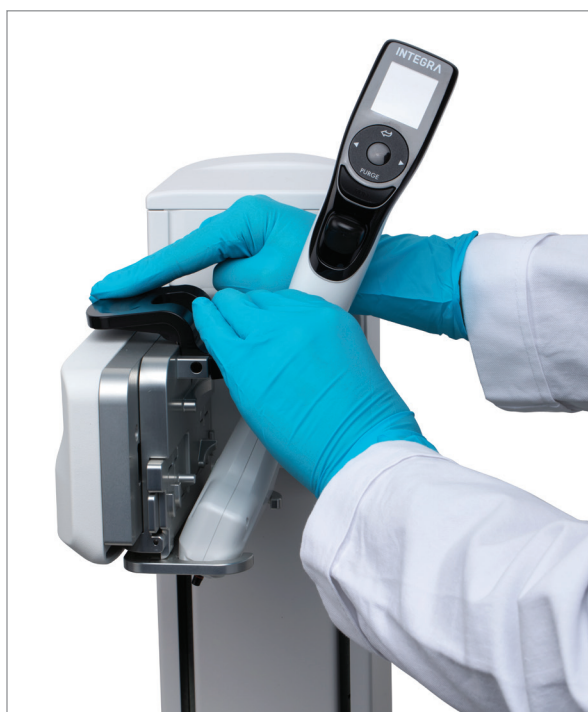
选择25款INTEGRA电动多通道移液器中的任意一款，装入ASSIST PLUS即可获得卓越的工作流程灵活性。
