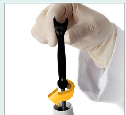
Outil polyvalent (3200) pour le calibrage, le retrait de joint et le changement de ressort du piston
