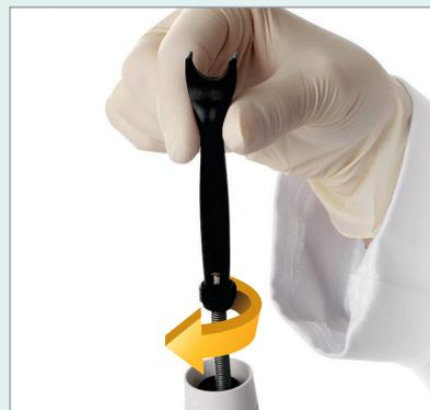
メンテナンス用多目的ツール：キャリブレーション時の補正作業、Oリングの取り外し、プランジャーばねの交換
