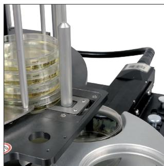
Die erhältlichen Verbindungskits erlauben das Bedrucken der Petrischalenseitenwand mit allen unterstützten Tintenstrahldruckertypen. Alternativ können Petrischalen mit Hilfe des LINX Tintenstrahldruckers am Boden bedruckt werden.
